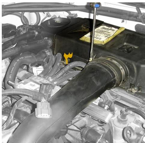
۳- لوله ورودی هوا به فیلتر هوا را با باز نمودن بست آن آزاد
